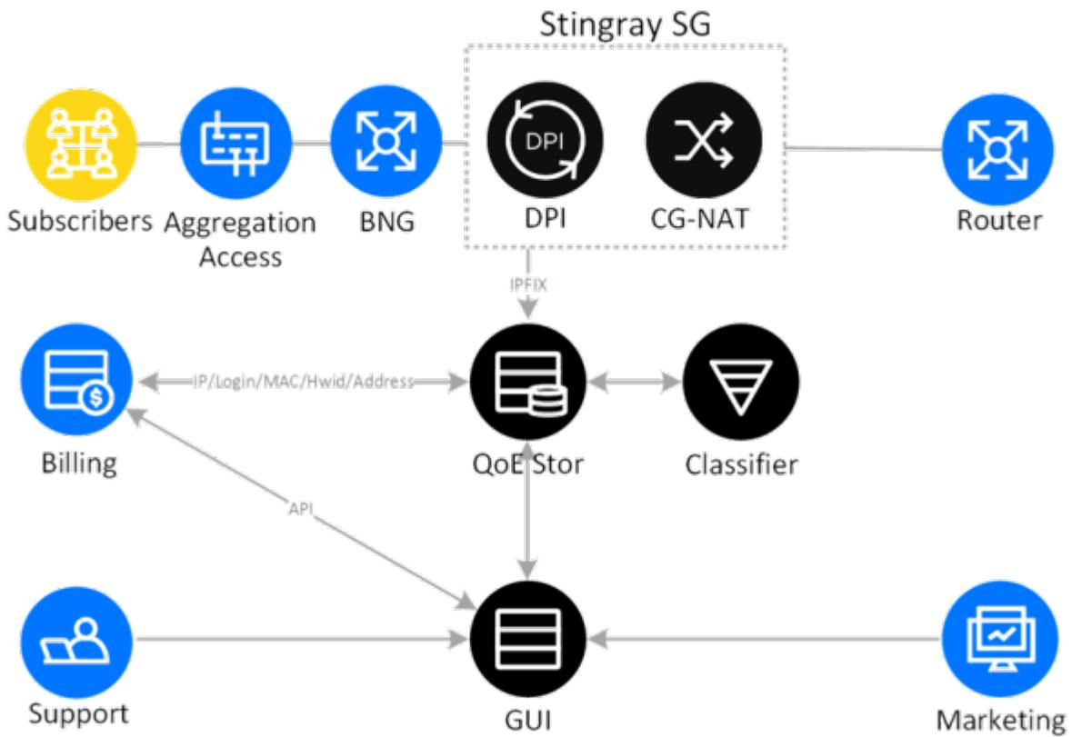
Мы предлагаем совместить функционал CG-NAT с DPI на одном устройстве, чтобы получить возможность не только транслировать адреса, но также распознавать и классифицировать трафик по протоколам и направлениям, использовать полисинг общего канала, размечать трафик, работать со статистикой (Full NetFlow и Clickstream).
