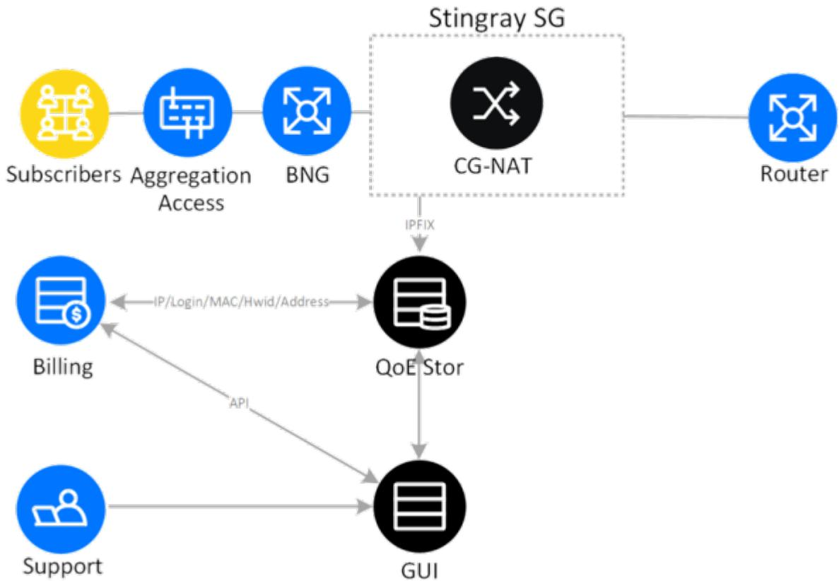
Классическая схема включения устройства CG-NAT в сеть — между BNG и роутером для обеспечения трансляции сетевых адресов. NAT log передается по протоколу IPFIX (NetFlow v10) на выделенный сервер или VM, где установлена база данных QoE Stor и GUI. Данное решение позволяет эффективно хранить и осуществлять поиск в NAT log.
