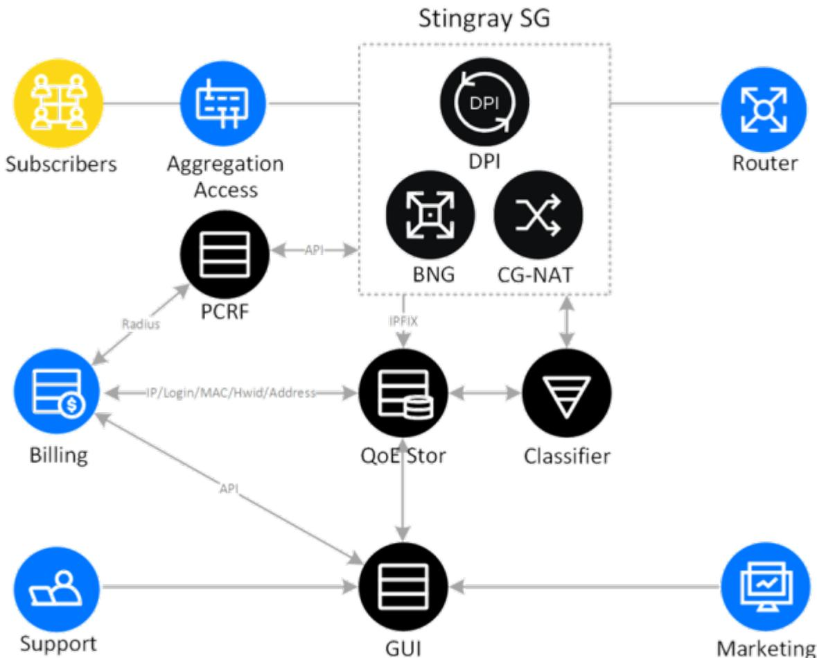
Наиболее выгодный вариант — совместить функциональность CG-NAT, DPI и BNG на одном устройстве и таким образом построить гибкое и легко управляемое ядро сети — это значительно сокращает совокупную стоимость владения (TCO, Total Cost of Ownership) за счет компактности, высокой производительности, единообразного управления и эксплуатации.
