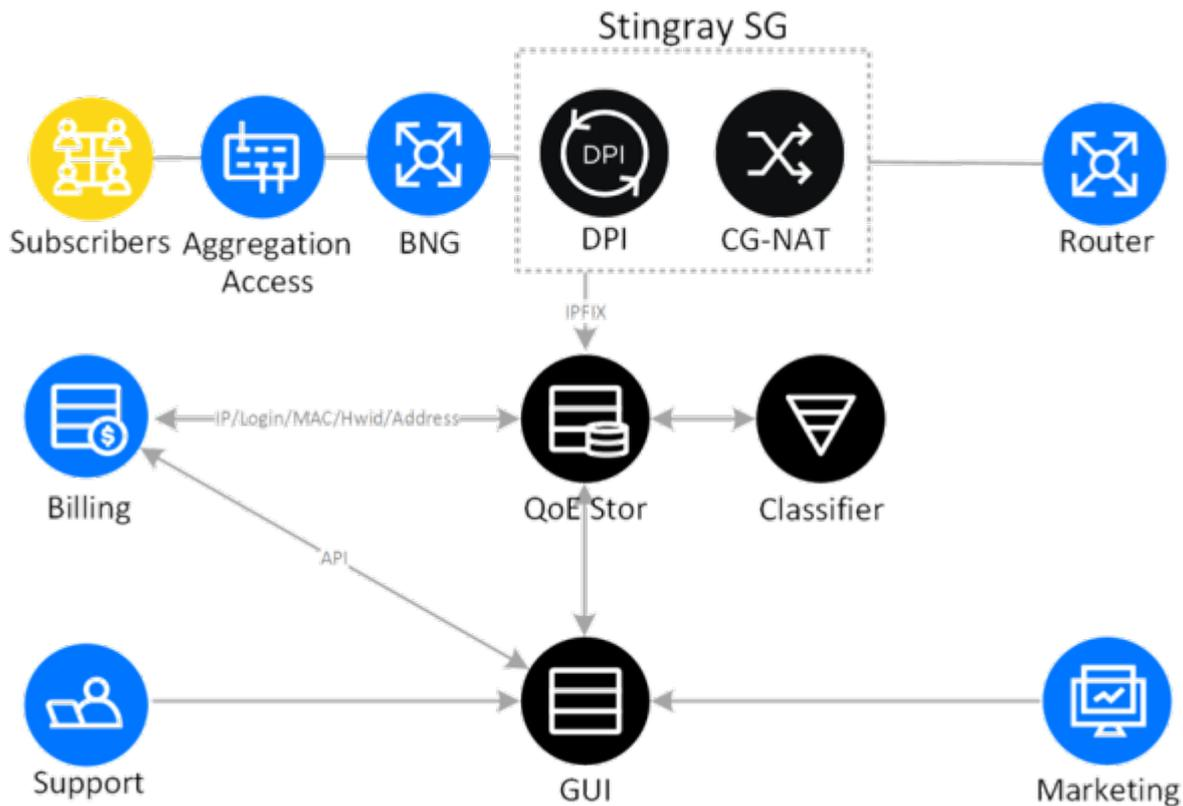
Мы предлагаем совместить функционал CG-NAT с DPI на одном устройстве, чтобы получить возможность не только транслировать адреса, но также распознавать и классифицировать трафик по протоколам и направлениям, использовать полисинг общего канала, размечать трафик, работать со статистикой (Full NetFlow и Clickstream).
