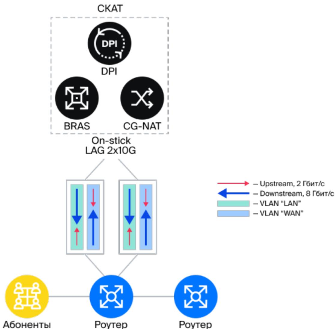
Каждый on-stick порт описывается особым образом: сначала описывается базовый физический порт с помощью `drdk_device`, затем описываются виртуальные порты, основанные на базовом.
