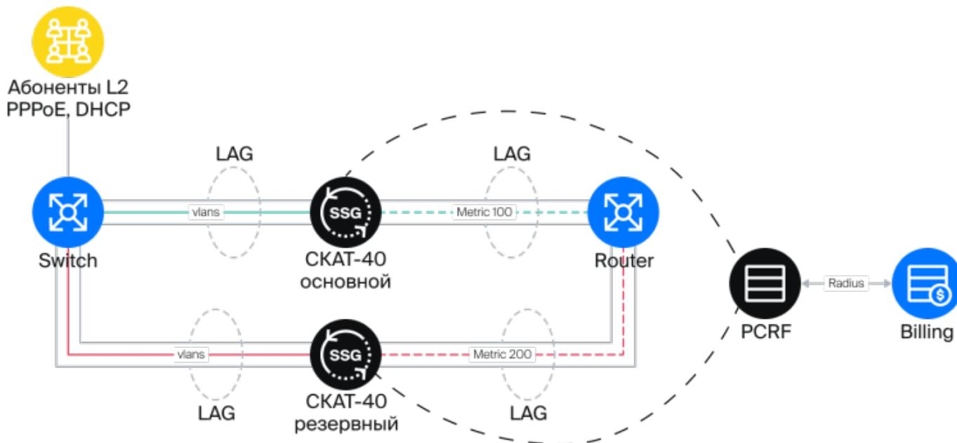
Для первого варианта применяется следующая схема репликации для согласования данных об абонентах на всех fastDPI-серверах: fastPCRF шлет ответы авторизации и CoA-запросы на все fastDPI серверы, перечисленные в параметрах `fdpi_server`.
