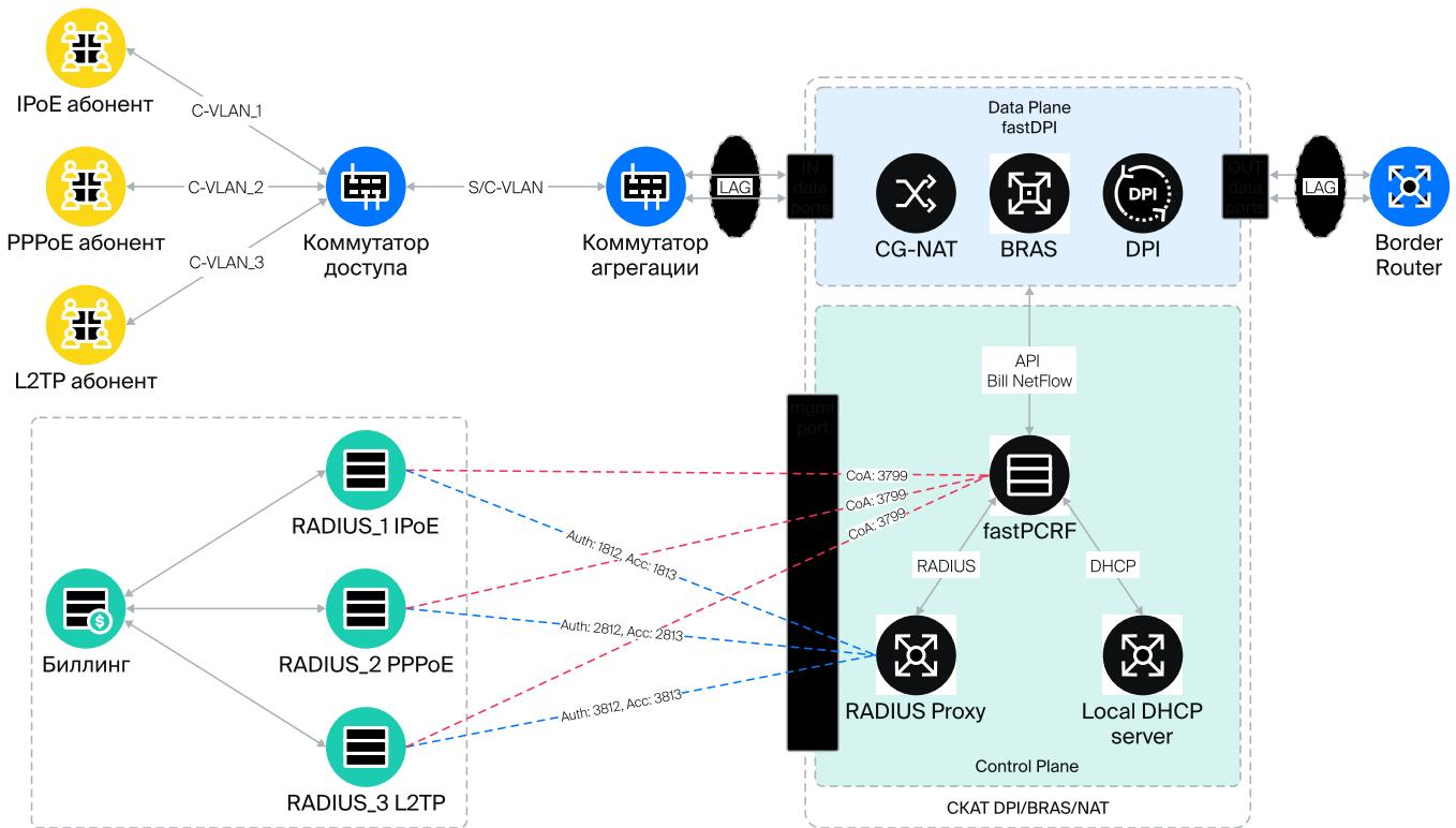
В данном примере рассмотрим распределение авторизации и аккаунтинга в режиме load-balance для разных типов доступа между группами RADIUS-серверов:
