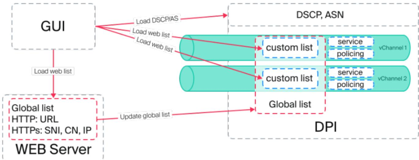
Для централизованной загрузки Глобальных списков на DPI используется выделенный web сервер. FilterUI выгружает списки на данный сервер в подготовленном формате для DPI. Каждый DPI скачивает данные списки и применяет в соответствии с правилами. Так же FilterUI выгружает уникальные правила на каждый DPI. При необходимости данные списки объединяются и применяются на канал или абонента.
