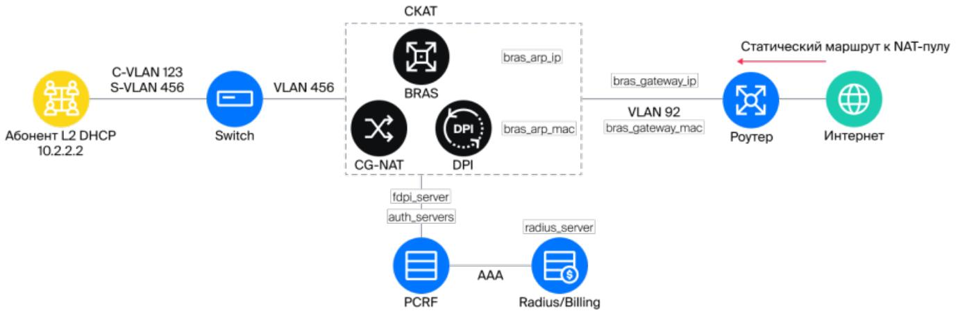
BRAS DHCP L2 означает, что абонент получает IP-адрес через DHCP Proxy и проходит AAA в Биллинге. Дальше терминируется CKATом и попадает на бордер.
