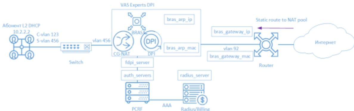
FastDPI BRAS начиная с версии 7.2 поддерживает PPPoE. Абонент подключается к СКАТ, используя тип подключения PPPoE. Дальше терминируется СКАТ и попадает на бордер.
