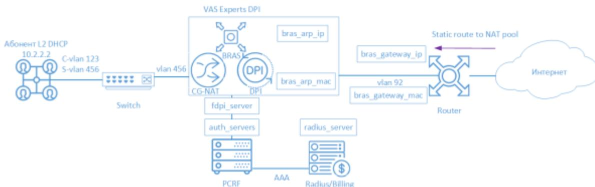
BRAS ARP L2 означает, что абонент настраивает IP-адрес статично на своем устройстве и проходит AAA в Биллинге при отправке ARP запроса к своему шлюзу по умолчанию (также возможна схема, когда абонентам выдается префикс /30). Далее терминируется СКАТом и попадает на бордер.
